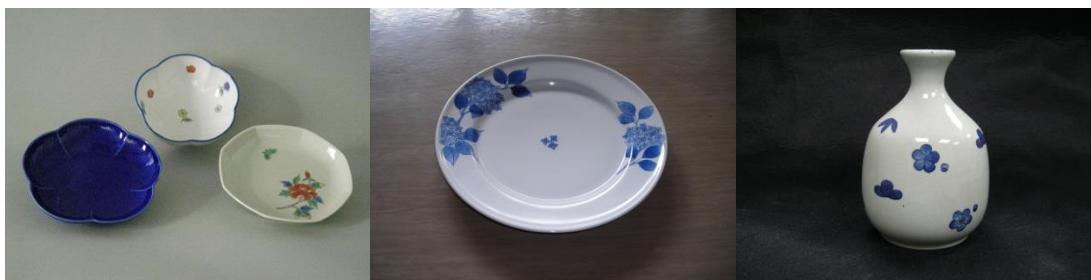
左：鋳込み成形、中：ローラーマシン成形、右：土物風合い磁器
