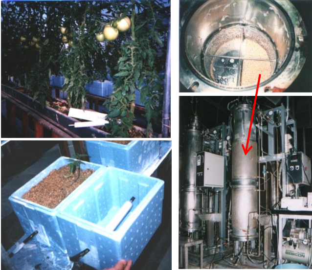
栽培用担体、バイオリクター担体としての活用事例(粗粒石英質多孔体)
