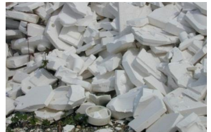
廃棄された石膏型
