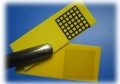
台紙が紙なので・・・簡単にニューセラ材料の厚膜が貼れて、簡単に重ねることができる。
