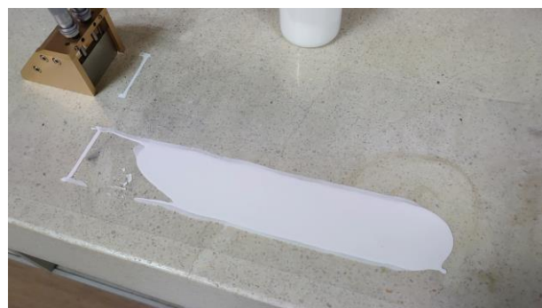
図2 フィルムアプリケーターを用いて作製したグリーンシート。
