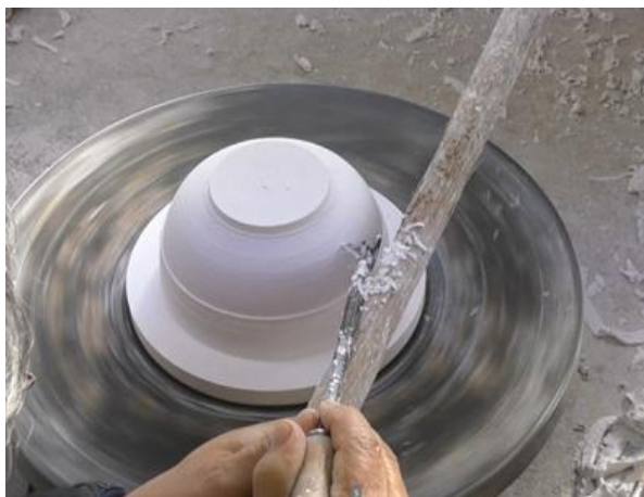
図1 内ゴテ成形用原型の製作
