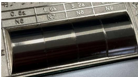
図12 目標とする表面アラサ(日本金属電鍍製 円筒用標準粗さ片).
