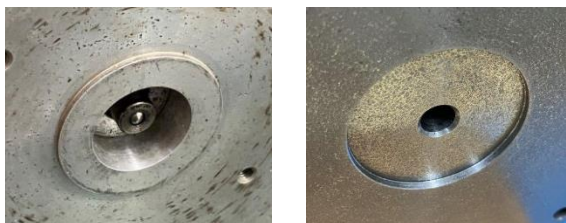
図7 左は、機械側(凸)、右は、ローラー側(交差: φ +0.03 mm).
