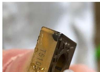
図10 刃物先端の工具チップ上の構成刃先
