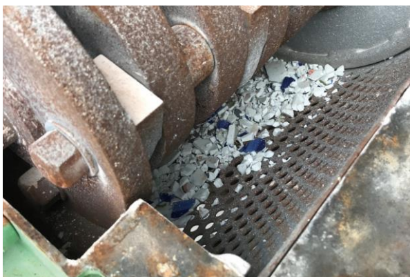
ハンマークラッシャーにより「べんじやら」に粉碎加工する様子
