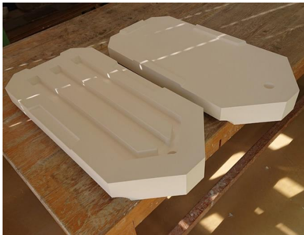
図7 ボーダータイル用圧力鑄込み石膏型
