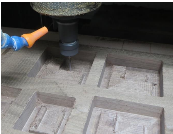
図3 CNCミーリングによる木材の切削
