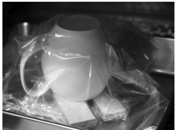
図10 恒温器内でワックスを溶出させる様子。
