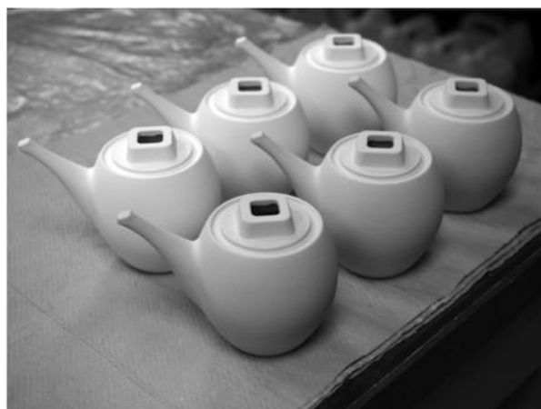
図4 3D プリンターにより製作した中子.
