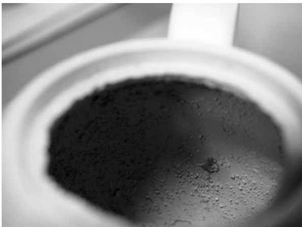
図 12 成形体内部に転写されたワックス製中子の気泡。
