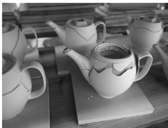
図7 成形体が乾燥収縮に耐えられずヒビ割れを起こした様子.
