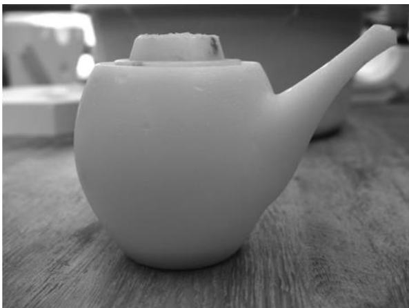
図 13 気泡が低減されたパラフィンワックス製中子。
