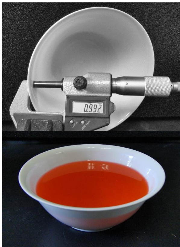
図16 薄造り試験結果(上:施釉体厚さ,下:透けの様子)
