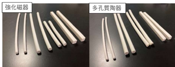
図13 押出成形のテストピース(1300℃酸化焼成、昇温速度 200℃/h、保持時間 1h).
