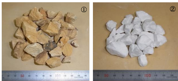
図1 低品位天草陶石①及び酸処理後陶石②の外観。
