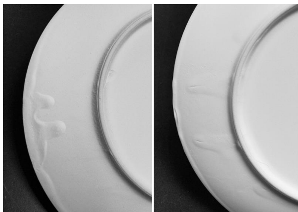
図7 釉ムラの発生状況 (左:重ポーム度 38—施釉時間 5 秒、右:重ポーム度 44—施釉時間 1 秒)
