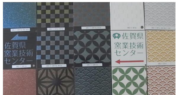
図13 ほうろう下釉上及び上釉上へ用いた光彩ほうろう上釉加飾材試料
