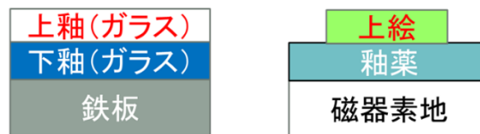
ほうろうの構造モデル(断面) 陶磁器の構造モデル(断面)
