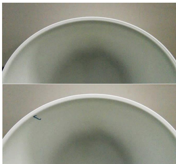
図9 縁形状の違いの様子。 (上:正常、下:異常(土切が内側Rをつぶしている))
