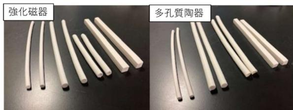
図13 押出成形のテストピース(1300℃酸化焼成、昇温速度 200℃/h、保持時間 1h).
