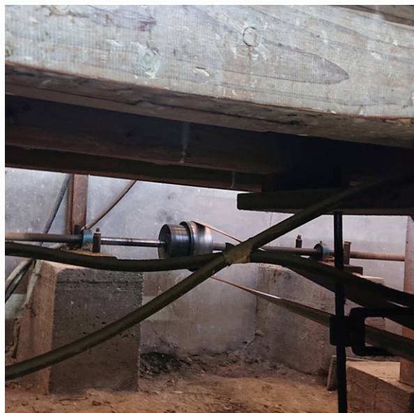
図4 動力の伝達 平ベルトによりシャフト軸からろくろ軸へ。
