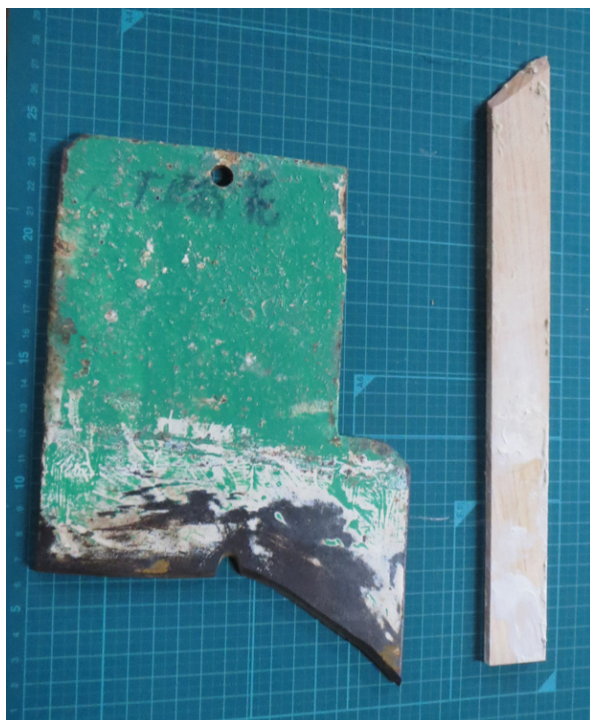
図9 撮影時使用したコテとヘラ コテは鉄板5mm厚、ヘラは松材.
