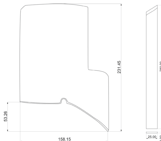
図10 撮影時使用したコテとヘラ コテは鉄板5mm厚、ヘラは松材.
