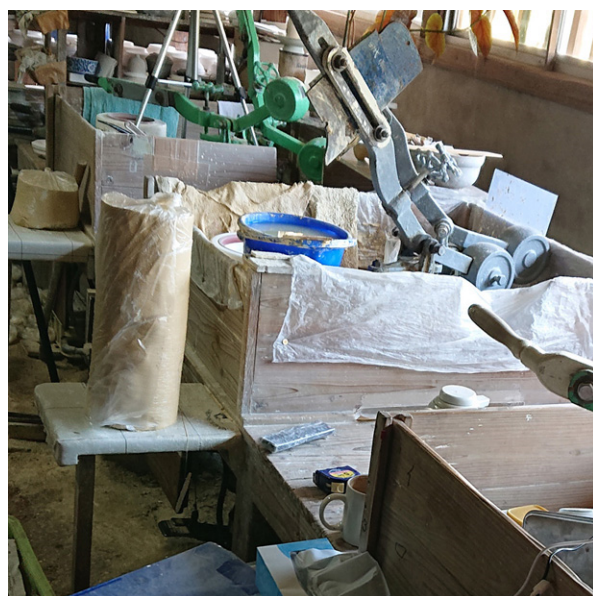
図2 3連機械ろくろ ダブルアーム、真空式ダブルペダル仕様
