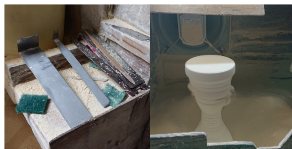
図11 削り仕上げ道具 万年ガナ (左) 陶枕(トチミ)(右).
