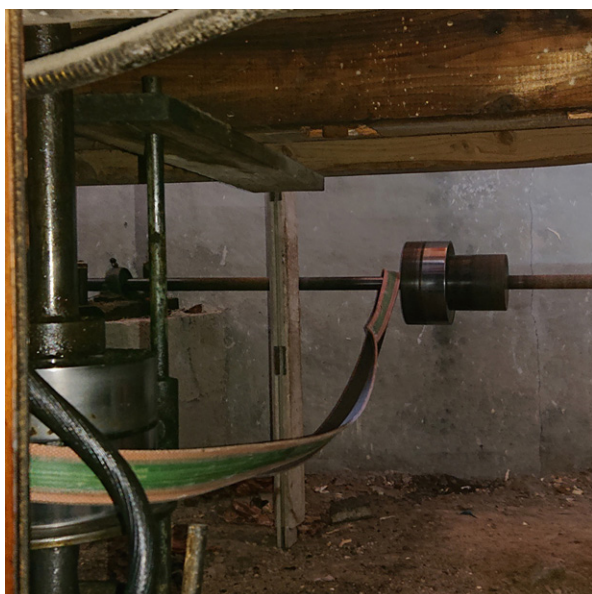
図5 動力の伝達 平ベルトは簡単に装着、脱着ができる。
