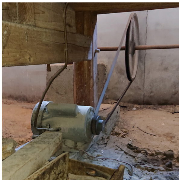
図3 動力 0.75kw モーター×1、Vベルト式駆動1本シャフト。
