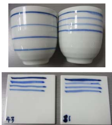
図3 トンネル窯で焼成した湯呑み及びテストピース。(左:No.43, 右No.81)
