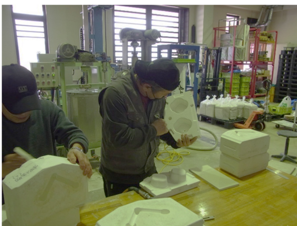
図2 生地業者による鑄込試験の様子2.
