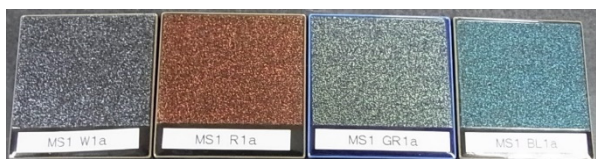
図11 光彩顔料のチタニア膜厚の違いによる光彩上絵発色変化.
