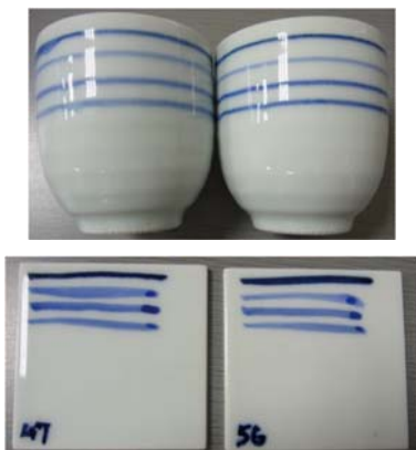
図5 トンネル窯で焼成した湯呑み及びテストピース (左:No.47, 右:No.56)
