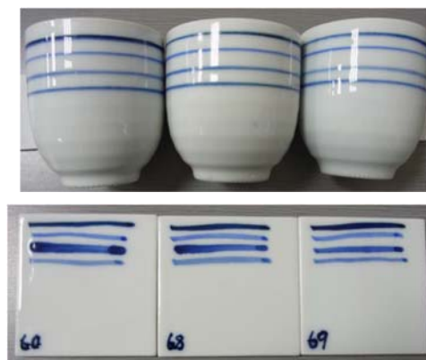
図7 トンネル窯で焼成した湯呑み及びテストピース (左:No.60, 中央:No.68, 右:No.69)
