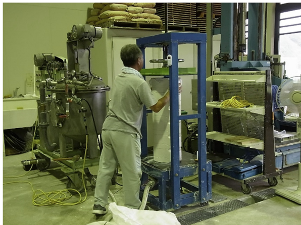
図1 生地業者による鑄込試験の様子1.
