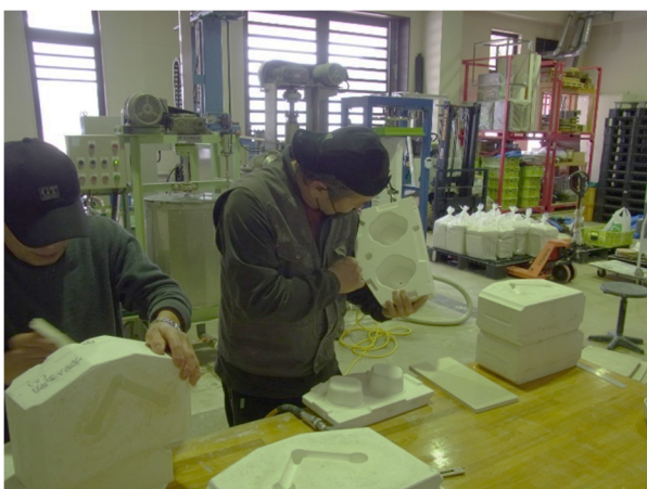
図2 生地業者による鑄込試験の様子2.
