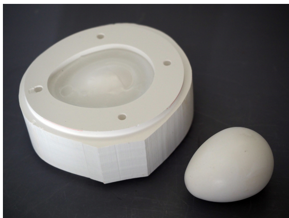
図6 両面切削による原型の試作.
