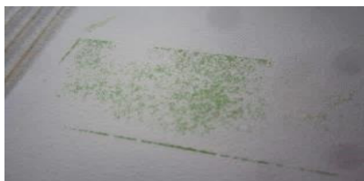
図 6 セッターへの活性層の付着状況。
