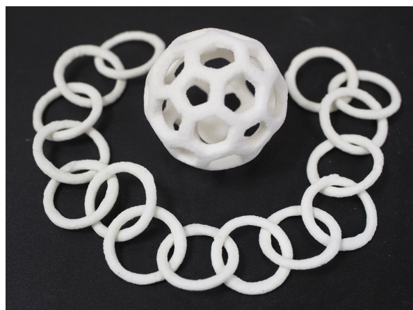
図 1 C3DPO:陶磁器ダイレクトプリントアウト技術の試作品。
