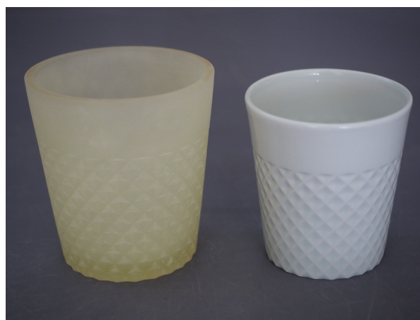
図 3 インクジェット式 3D プリンターによる原型(左)と試作品(右)。
