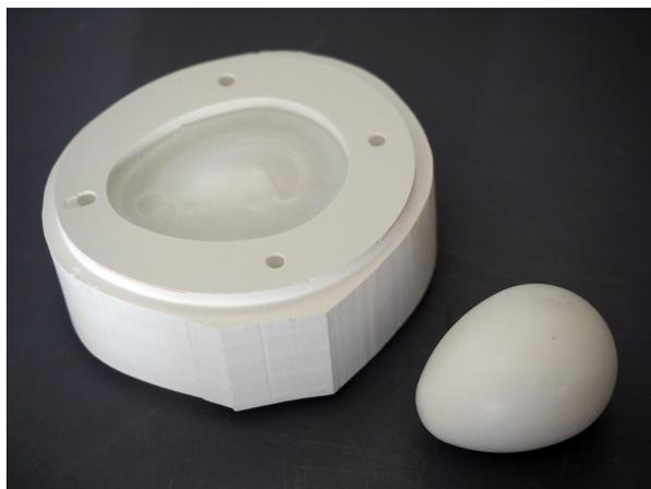
図 6 両面切削による原型の試作.
