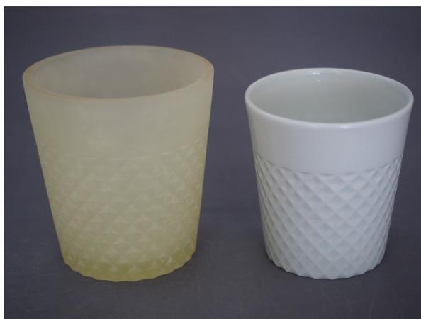
図 3 インクジェット式 3D プリンターによる原型(左)と試作品(右)。
