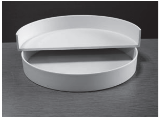
図9 凝集剤添加による乾燥割れ防止例 (上段:素焼き断面 φ195mm h30mm 縁厚3mm 下段:締め焼き φ182mm h28mm 縁厚2.5mm)
