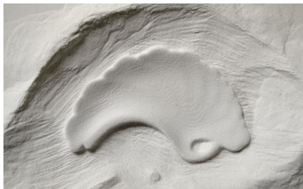
図 1 陶磁器粉末を原料として造形した試作品。
