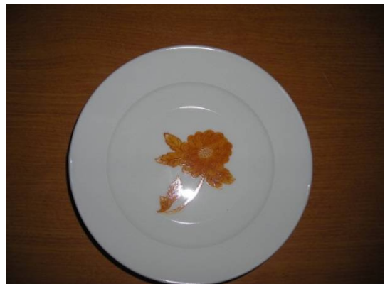
図 3 水熱合成法で得た弁柄を用いた赤上絵具.
