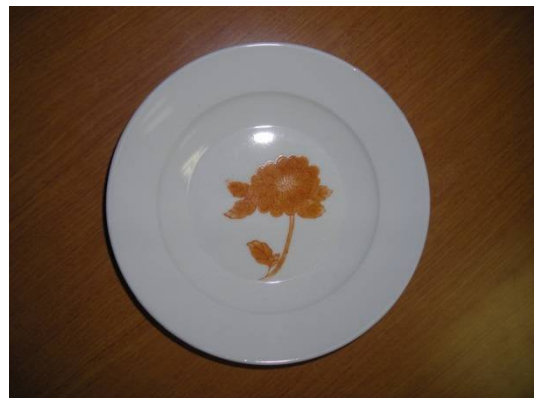
図 4 中和沈殿法で得た微細弁柄を用いた赤絵具.
