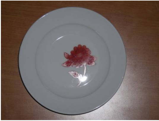
図 5 中和沈殿法で得た中細弁柄を用いた赤絵具。
