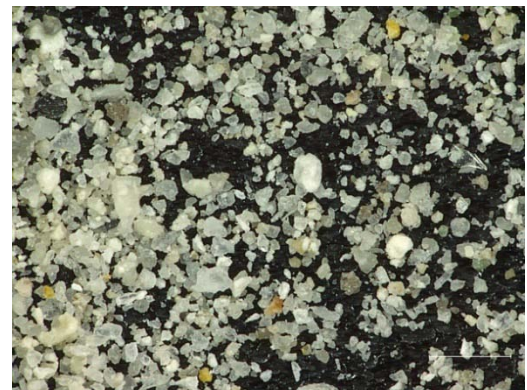
図6 水簸後の粗粒子の光学顕微鏡写真 石英と長石粒子が混在 (—— 500 \mu m)
