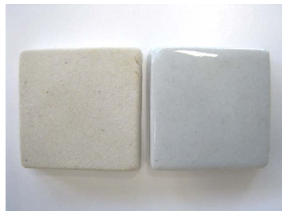
図 9 1300℃-還元ガス炉による試験体 左側がいずれも無釉の試験体
