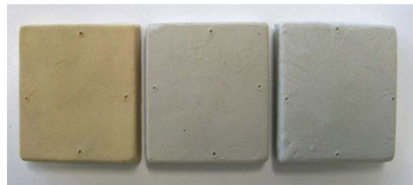
図 8 電気炉で焼成した成形体の外観 左より 1070、1210、1250℃-1 時間焼成
