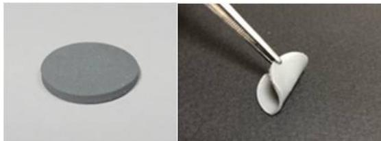
図 12 粒子径が異なる 2 種のフィラーを配合(細粒:粗粒=3:7)した h-BN60%混合のシート成形体。
