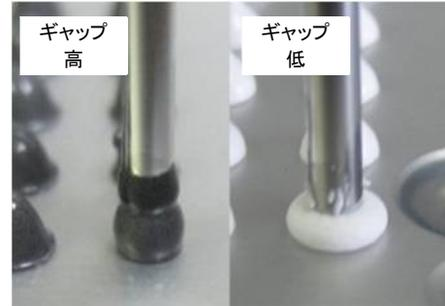
図6 ノズルの吐出高やペースト粘性違いによるポットティング1滴の形状変化。
