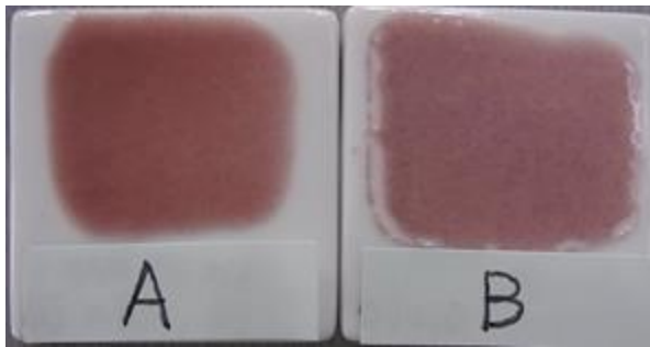
図3 開発した無鉛銅上絵 (ABの試料は無鉛フリットの種類が異なる)
