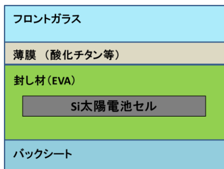
図1 酸化チタン薄膜を導入したSi太陽電池モジュールの概念図
