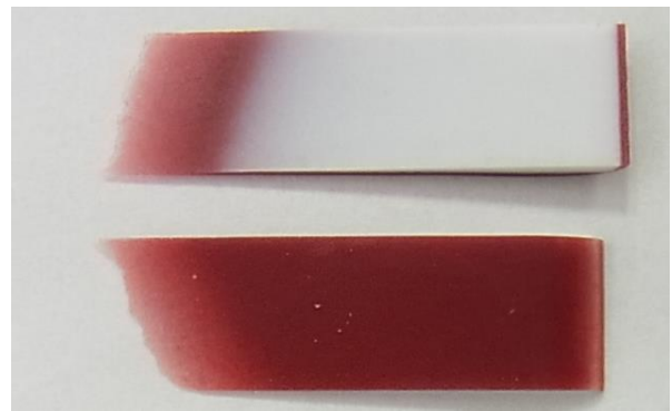
図2 銅赤釉試料(シンクロトン分析用試験片)
