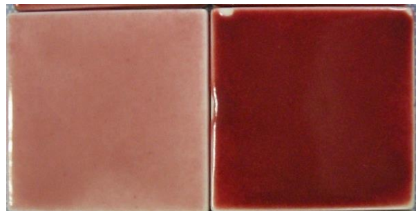
図6 辰砂釉(銅赤釉)の再焼成による色変化例 左:再焼成前、右:1100°C再焼成後
