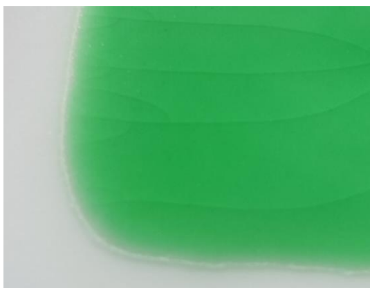
図9 上絵試料に発生したクラックの例
