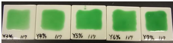
図7 顔料添加量に変化による上絵発色試験結果 左から添加量 3%, 4%, 5%, 6%, 7%
