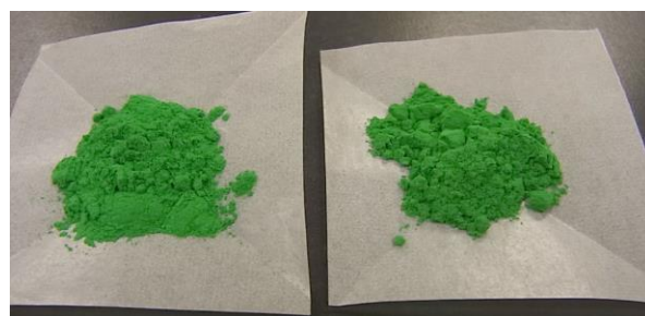
図1 緑色顔料試料 左側 Y_2BaCuO_5 右側 (Y_{0.9}Lu_{0.1})_2BaCuO_5
