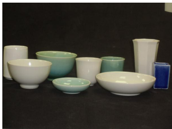
図7 酸処理陶土 1250°C焼成品
