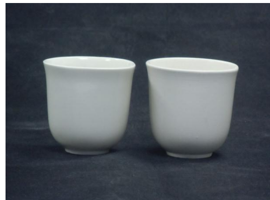
図6 酸化焼成 酸処理陶土 撰中陶土
