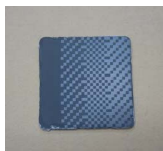
図 15 模擬バイオガスのみを供給しながら800°Cで4日間連続運転した後のコーティングパターン④の試作セル。
