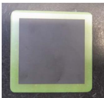
図 6 カソード積層後の SOFC 単セル。
