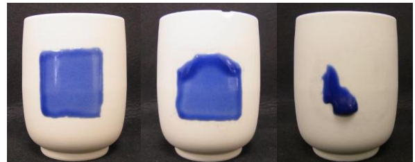
図3 焼成後の釉薬の融着状態(左からPVA、PVAc、CMC)。
