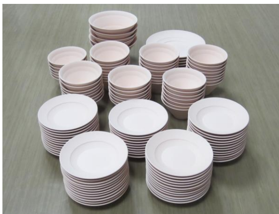
図 16 圧力鑄込み法で成形した試験体素焼の写真。
