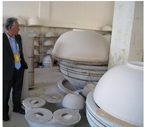
図 2 高氏薄胎大皇の素地工場。鑄込み型であるが、かなり大きな薄胎素地を作っている。
