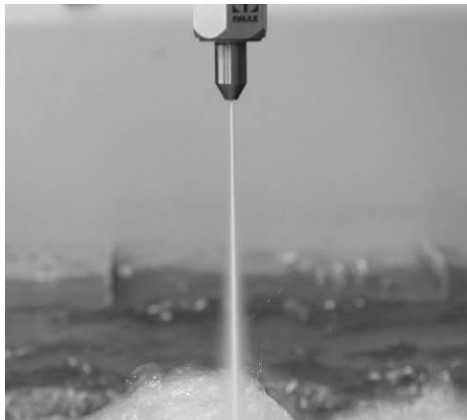
図4 ミキシングチューブ(タングステンカーバイト)の先端から水と研磨剤が噴射している様子。
