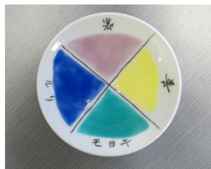
図4 配合 No.12 試験陶土における上絵適合試験
