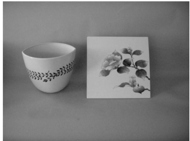
図 4 1トンロット試験土による鑄込み成形試作品
