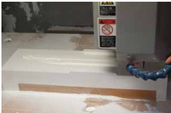
図3 NC 切削による型製作
