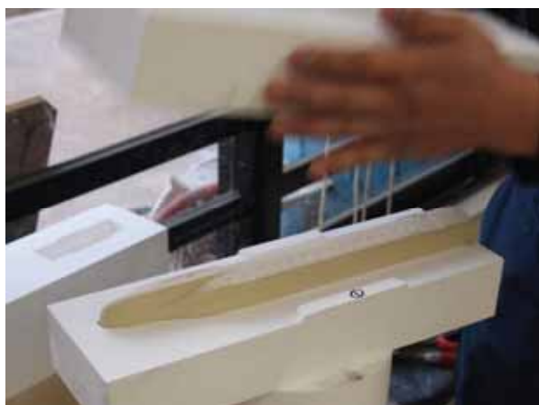
図4 鑄込成型作業
