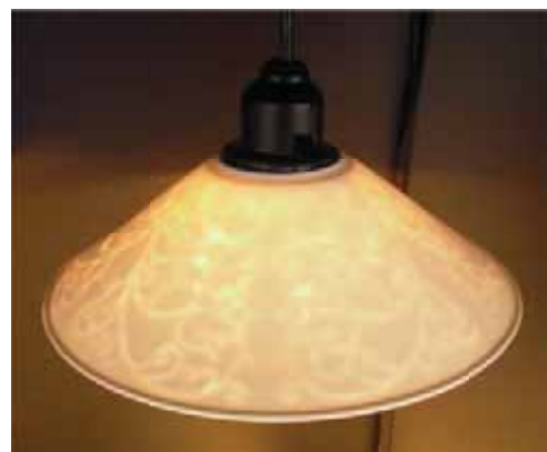
図8 サンドブラストによる加工。
