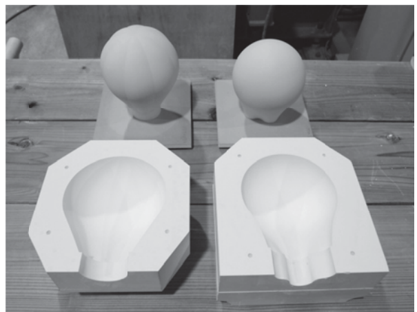
図 17 捨て型と鑄込み成形品。
