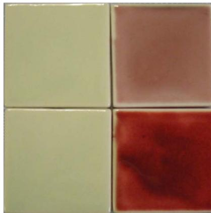
図2 銅釉の各焼成条件による発色変化および再加熱の影響 (CA 釉).
