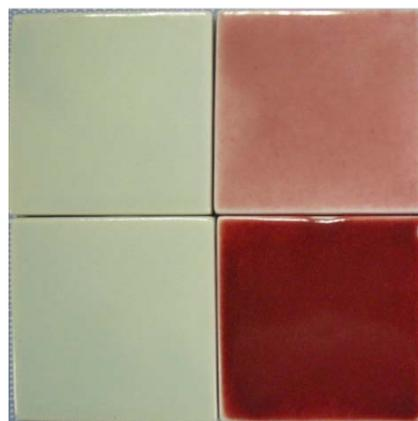
図3 銅釉の各焼成条件による発色変化および再加熱の影響 (BA 釉).
