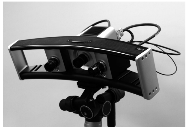
図1 デジタイザ Solutionix 社製 Rexcan III.
