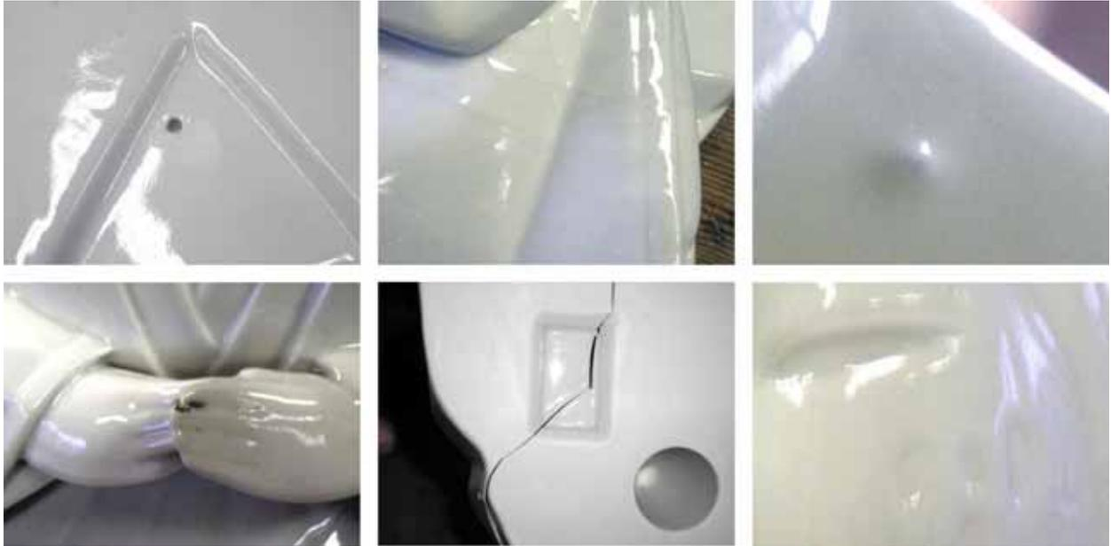
図3 鑄込成形により作製した素地に見られた欠点
