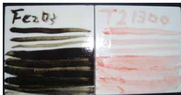
図11 下絵具発色試験 1300 酸化焼成
