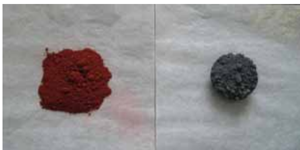
図1 ベンガラの焼成による色変化 (左；加熱前、右；1300 焼成後)
