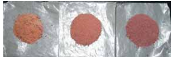
図5 \text{Fe}_2\text{O}_3 -シリカ複合顔料1300 焼成後
