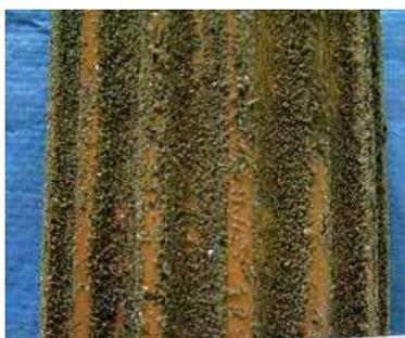
図 6 回収部材表面に付着した結晶物
