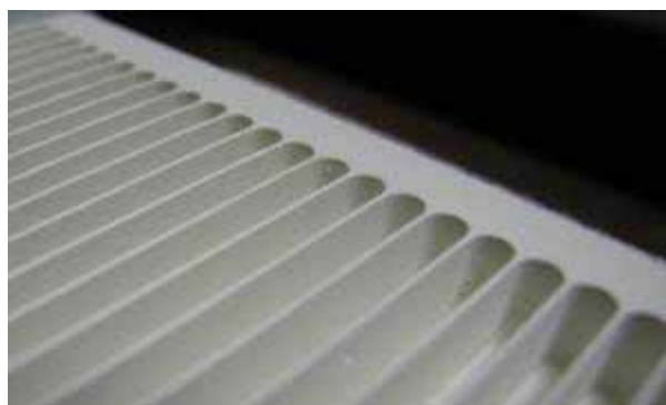
図9. エンドミルによる溝加工(刃径3mm)
