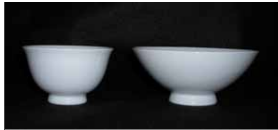
図 4 機械ろくろ成形による試作
