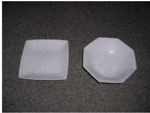
図 3 圧力鋳込み成形による試作
