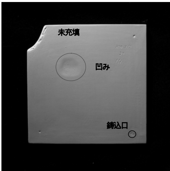
図 2 圧力鑄込における欠点例 (凹み、未充填)
