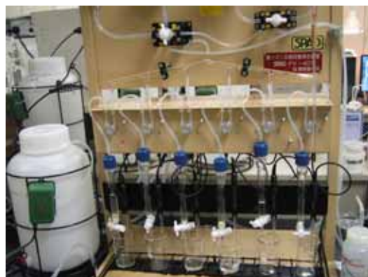
図2 簡易型陽イオン交換容量測定装置
