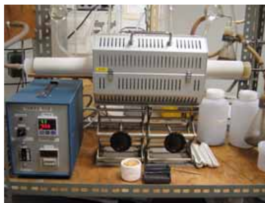
図1 籾殻の炭化装置(管状炉)
