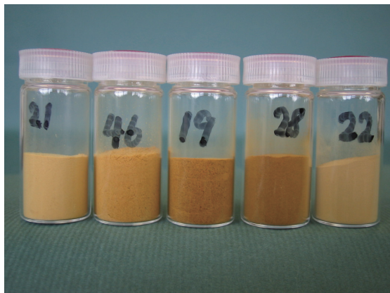
図2 黄色着色材 左から銀含有量4% (試料 No.21)、同6% (No.46)、同8% (No.19)、同21%(No.28)、同62%(No.22)
