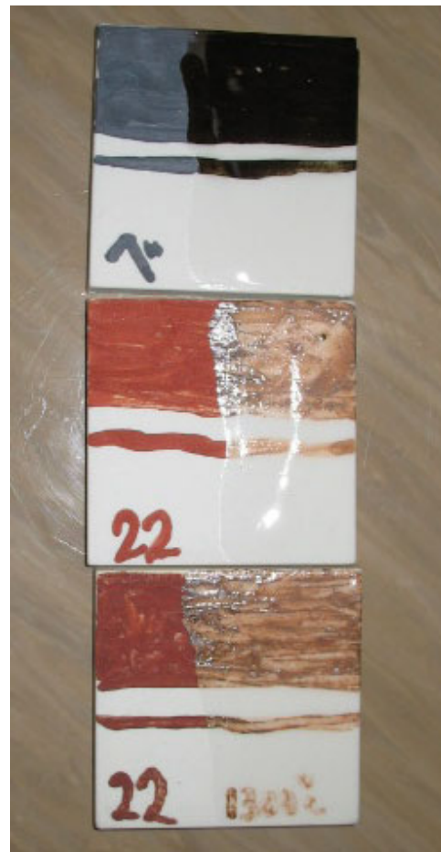
図6 下絵具試験；1300°C酸化焼成（上から市販のベンガラ、900°C処理試料、1300°C処理試料）
