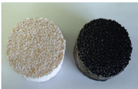
図 1 ペタライトフォーム(左)と酸化鉄系複合粉末 A をペタライトに 20 wt%添加して作成したセラミックスフォーム(1250°C)
