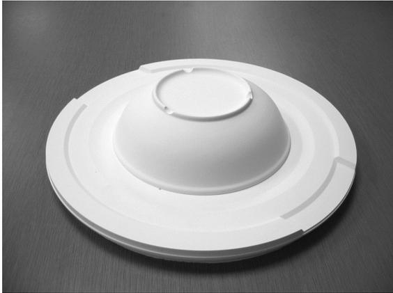
車用の蓋付き灰皿で、形状が非常に複雑であり、なおかつ高い精度が求められた。垂直部分が高く、NC 切削単独では製作困難であったため、紙積層造形機による原型用モデルを併用して制作した。
